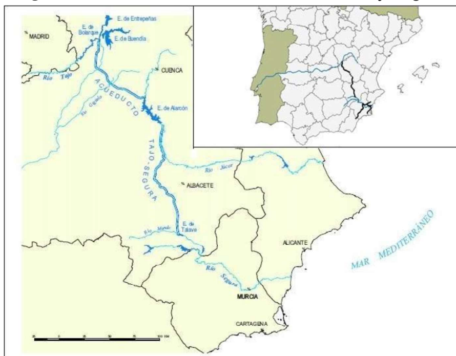
Figura 1. Infraestructuras básicas del Acueducto Tajo Segura.
