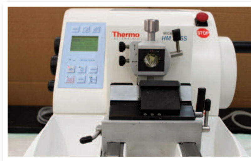
■ Figura 60. Microtomo Thermo HM 355S
