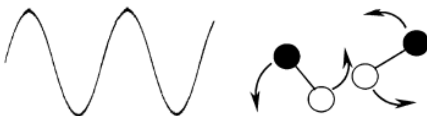
Figura 1.19. Moléculas dipolares las cuales intentan alinearse con un campo eléctrico oscilante (Lidström et al. , 2001).
