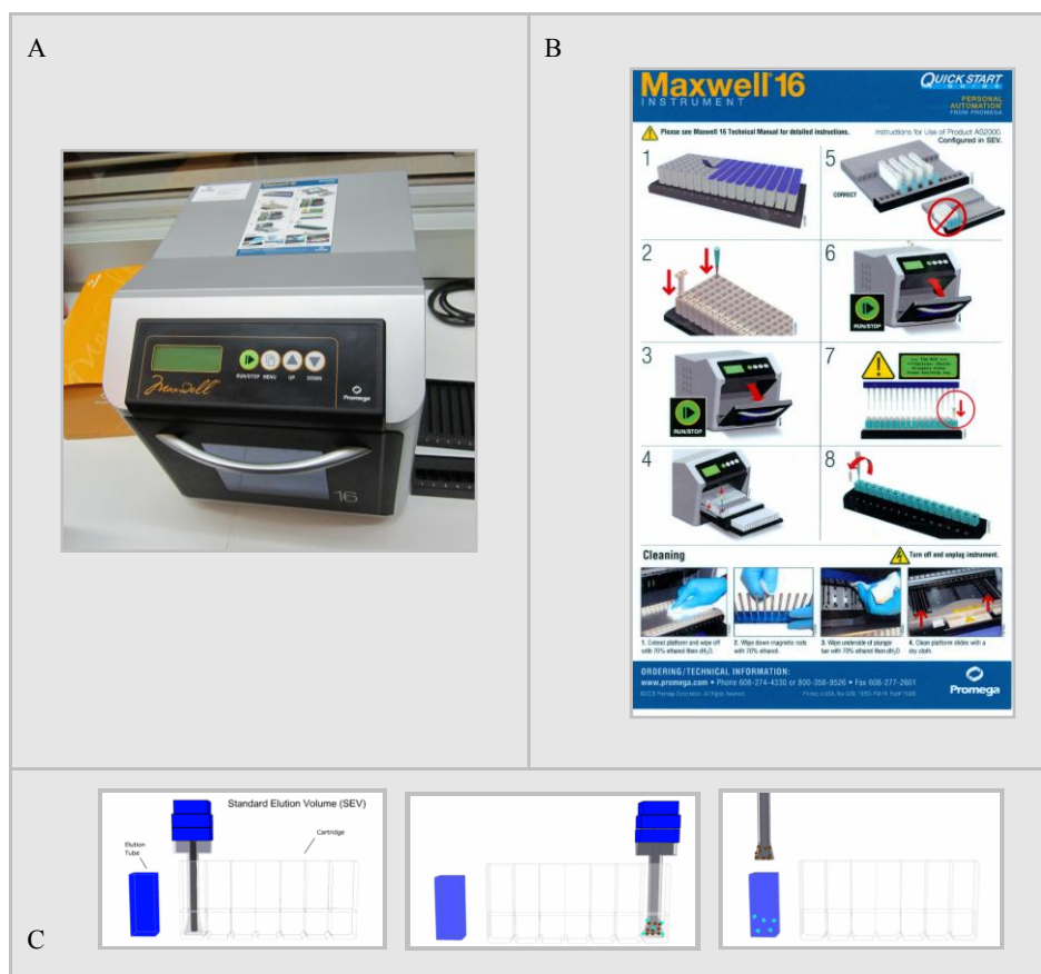
Figura 24. A. Maxwell 16 System. B. Guía de utilización del Maxwell 16. C. Esquema detalle de la extracción de ADN.
