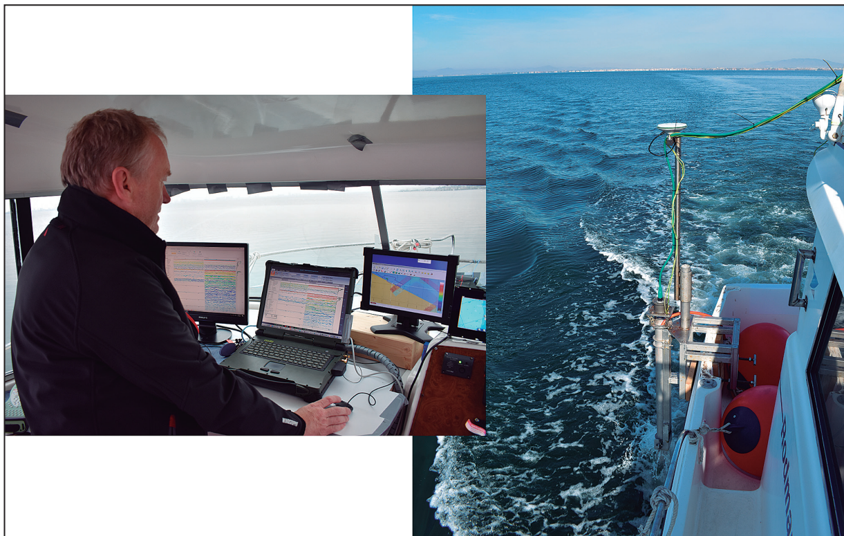
Figura 4. Fotografías de detalle durante la prospección geofísica del Mar Menor, incluyendo la instalación del perfilador sub-fondo, IMU y GNSS (dcha.) y área de control y dirección de los equipos en el interior de la embarcación (izq.).
