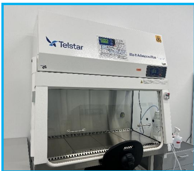
Figura 22. Cabina de seguridad biológica y química Clase II, tipo A2. TELSTAR Mod. Bio II Advance.
