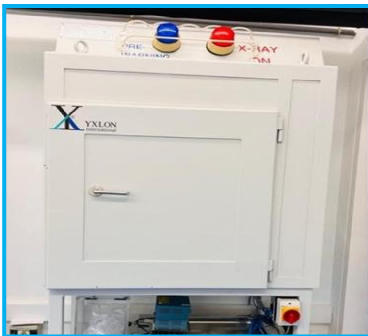
Figura 10 . Fuente de rayos X Smart Laboratory-ray, Model 583 E.
