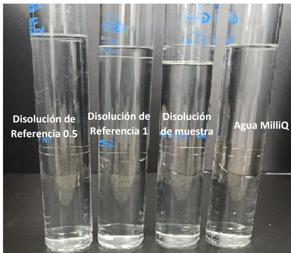
Figura 2.46. Test de claridad con tubos Nessler.
