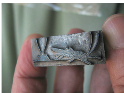
Fig. 5: Tipo móvil (Fundición Deberny, 1920)
