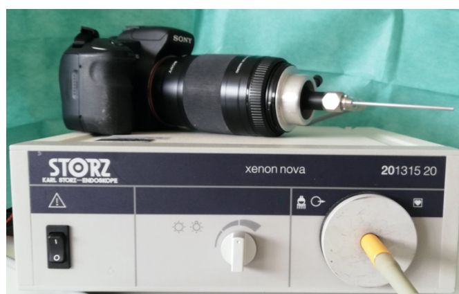
Figura 25: Cámara de fotos Sony con adaptador para fijación de óptica y fuente de luz fría
