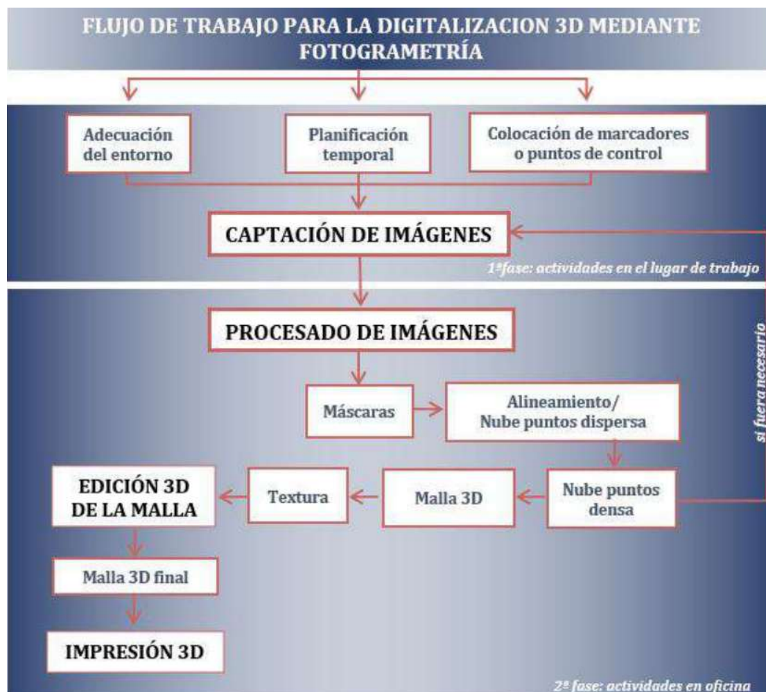
Figura 106. Diagrama del flujo de trabajo para la digitalización 3D mediante fotogrametría digital. Fuente: Melendreras et al. (2020).
