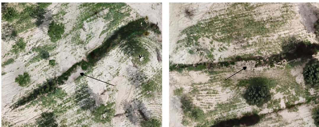
Figura 3.14: Detalle de movimientos en masa identificados a través de información espacial. Las flechas señalan la presencia del material acumulado como consecuencia de los movimientos en masa
