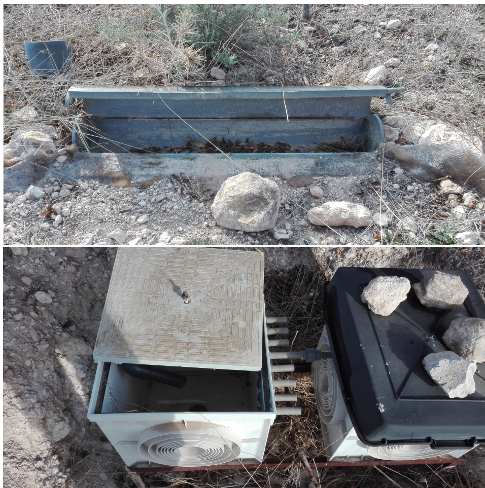
Figura 4.3: Detalle de una caja Gerlach (arriba) y de los dos depósitos (abajo) instalados en el cultivo de almendro
