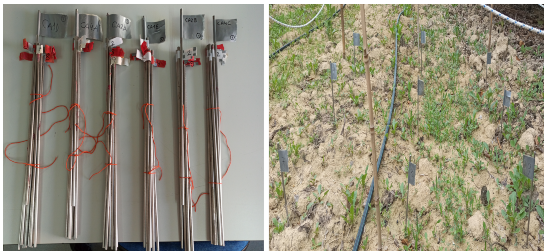
Figura 5.8: Fotografía de los paquetes de varillas de erosión a instalar (izquierda) y de una parcela de varillas instalada en una calle diversificada con cebada y veza (derecha) de la finca de regadío (Canteras)
