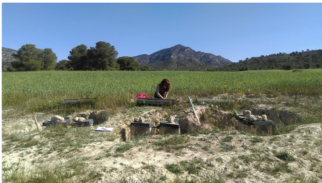
Figura 4.2: Sistema de retención de sedimentos (caja Gerlach + depósitos) instalado en la base de uno de los manejos implementados en el cultivo de cereal
