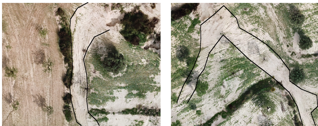
Figura 3.15: Detalle de la forma de erosión mixta identificada a través de información espacial. Las líneas negras delimitan la extensión de las formas de erosión mixta.
