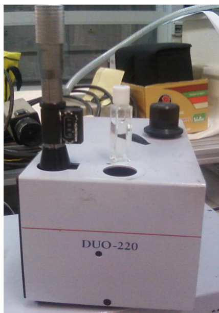
FIGURA 3.3: Plataforma para colorantes con tornillo micrómetro.
