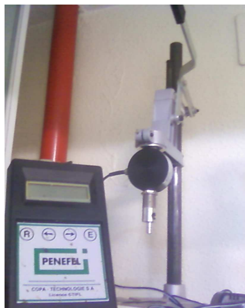
FIGURA 3.10: Penetrómetro utilizado para las medidas de dureza interna.
